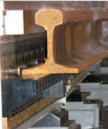
B) Schweißnahtvorbereitung der Herzstücke auf 2 x 5 m Länge
