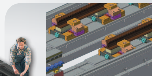
A) Fräsen der Zungen- und Backenschienen - je 24 m Magnetspannung - Anschlag und Basis separat ansteuerbar
