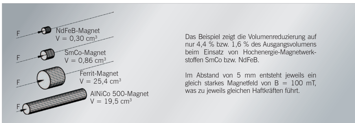
Abb. 7: Magnetvolumen für verschiedene Magnetwerkstoffe bei gleichem magnetischen Energieinhalt
