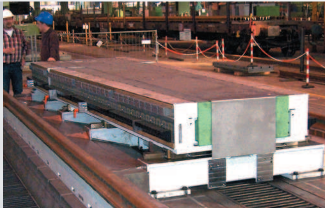
B) Schweißnahtvorbereitung der Herzstücke auf 2 x 5 m Länge
