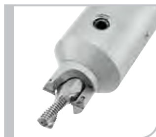
Kombinationswerkzeug mit Standard-Bohrgevindefräser M 12 x 1,5 1,5xD, IK und 2 Plansenkplatten
