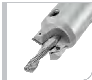
Kombinationswerkzeug mit Bohrgevindefräser M 12 2,5xD, IK Plansenk- und Anfasplatte
