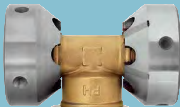
Schneideisen mit eingelöteten HM-Schneidstegen Thread cutting die with carbide-tipped (brazed)
