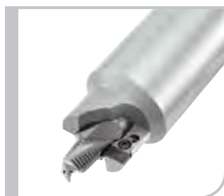
Kombinationswerkzeug mit Bohrgevindefräser M 16 x 1,5 stirnschneidig und einer PKD bestückten Konturplatte zur Bearbeitung einer vorgegossenen Bohrung
