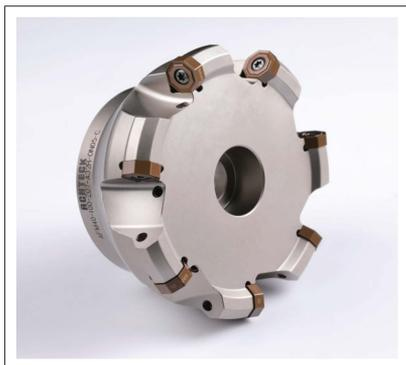
AFM40-ON05-C-45, с углом наклона 45°, пластины с геометрией Wire и 16 режущими кромками, для финишной обработки поверхности фланца турбокомпрессора.
