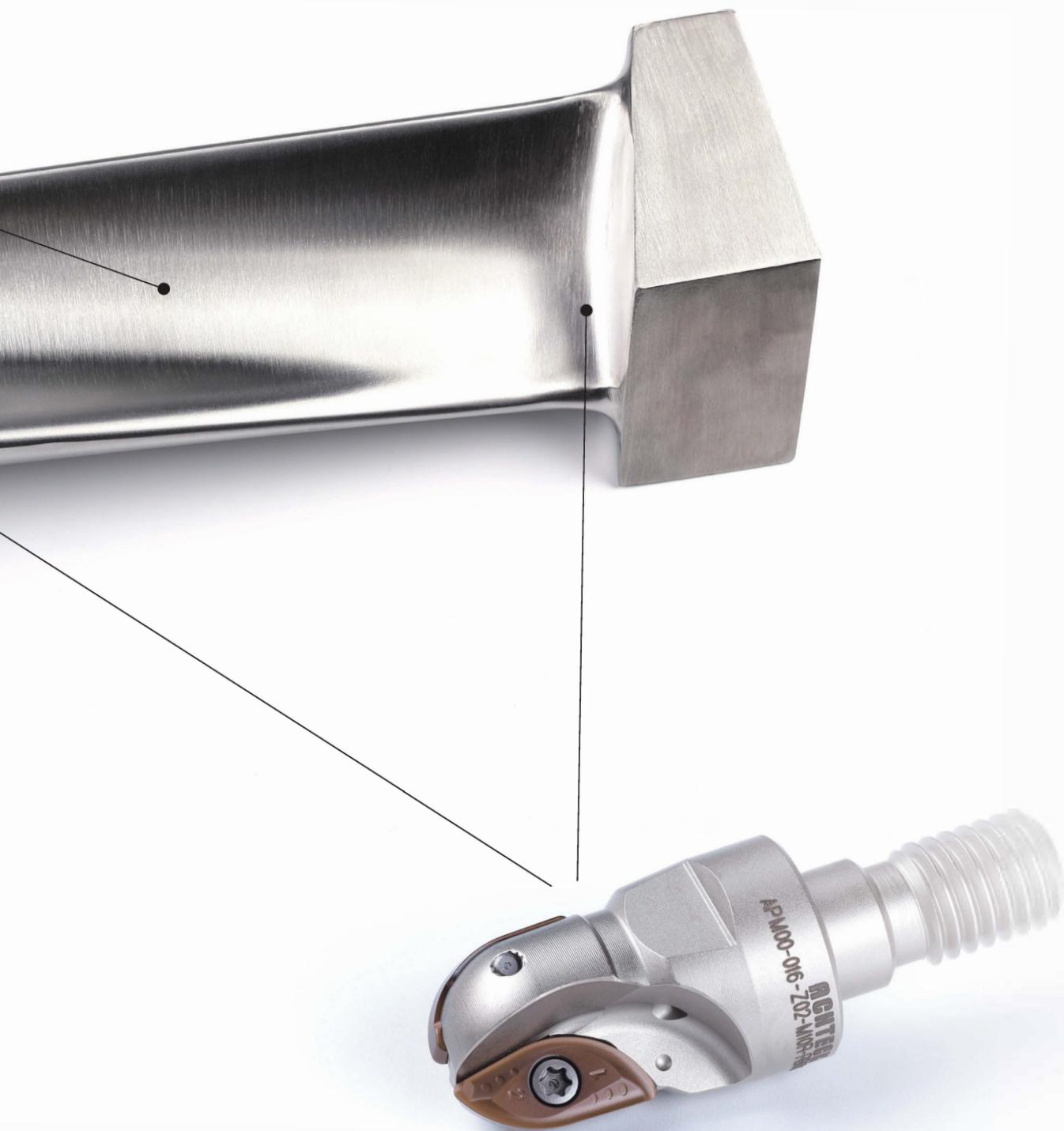
APM00-RBM08-20 Черновая обработка переходной зоны аэродинамического профиля между корнем и кожухом
