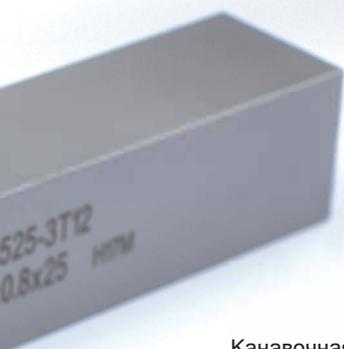
Канавочная державка ATSER2525-3T12 и канавочная пластина ATD 302-TS AP301 U применяется для обработки канавок на турбинном вале.
